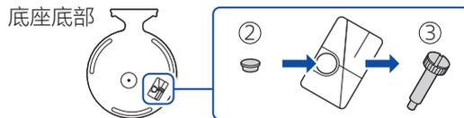
④ 安装底座，然后用手使用螺丝固定。也可以使用硬币拧紧螺丝。
