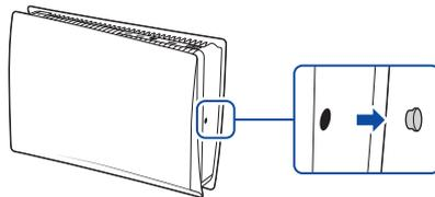
② 将螺丝孔盖帽安装到底座的底部。
