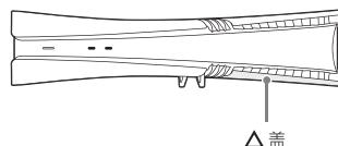
2 拆下扩充槽盖上的螺丝，然后将盖拆下。
