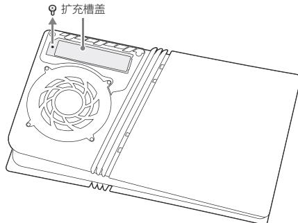
3 拆下螺丝和垫圈，然后将垫圈调整到M.2 SSD的尺寸。
