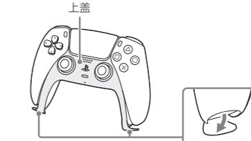
3 使用螺丝刀等工具拆下L1和R1键。
