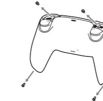
5 用螺丝刀等工具拆下盖扣 (①), 然后移除上盖 (②)。
