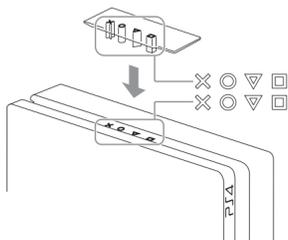
3 以橡膠部分朝上的方向拿住直立架。接著將直立架放到連接板上，讓凹洞對齊。
