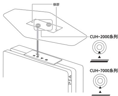
4 使用硬幣或類似的平面物體來旋緊安裝螺絲。
