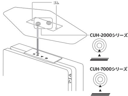
4 コインなどで取り付けネジを締める。
